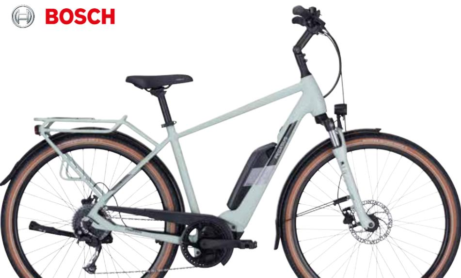
28 Zoll | SHIMANO Alivio 9-Gang Schaltwerk | pannensichere SUPERO Optima Safe Reflex Bereifung | Performance Line CX Mittelmotor Akku: 400 Wh/gegen Aufpreis 500 Wh | LED-Scheinwerfer vom Display aus bedienbar
