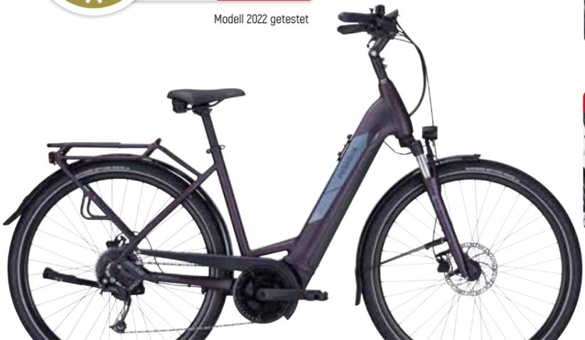
pannensichere SUPERO Optima Safe Bereifung | hydraulische Scheibenbremsen von TEKTRÖ | Performance Line Mittelmotor Akku: 400 Wh/gegen Aufpreis 500/625 Wh | SHIMANO Alivio 9-Gang Schaltwerk
