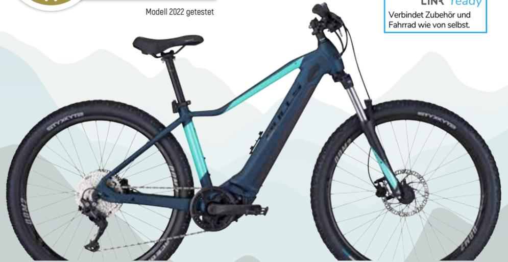
**BULLS** **27,5 Zoll** Performance CX Line Mittelmotor Akku: 400 Wh/gegen Aufpreis 500/625 Wh **SHIMANO Deore** 10-Gang Schaltwerk
