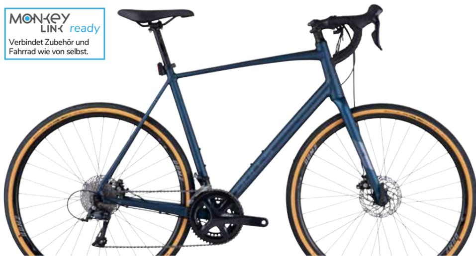
**BULLS** **28 Zoll** **SHIMANO GRX 20-Gang Schaltwerk** **hydraulische Scheibenbremsen von SHIMANO**
